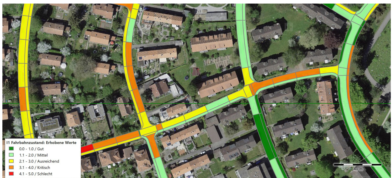
Spurflächen eingefärbt nach I1-Fahrbahnzustand
